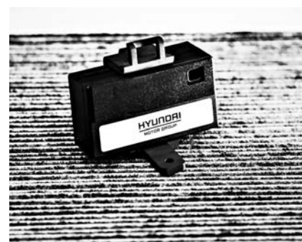
현대자동차와 기아자동차는 실내 미세먼지 농도를 측정하여 스스로 자동차 내부의 공기를 정화하는 레이저 센싱 기반 지능형 공기청정 시스템을 개발했다. /현대차그룹 제공
