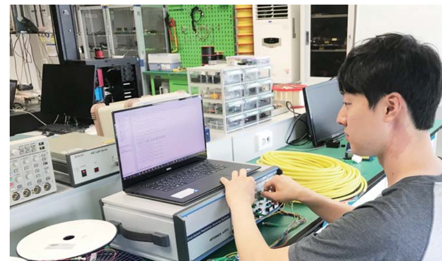
한국광기술원 연구원이 분포형 방사선 감지 및 모니터링 시스템의 시험 및 기술검증을 실시하고 있다.
