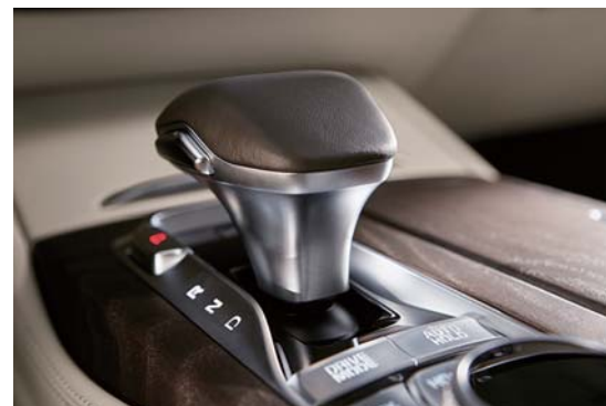
전자식 변속레버 변속기와 변속레버가 전자 통신 제어로 작동하는 시스템으로, 변속 레버의 진동이 없고 적은 조작력과 동선만으로 변속이 가능해 편의성이 뛰어나다.
