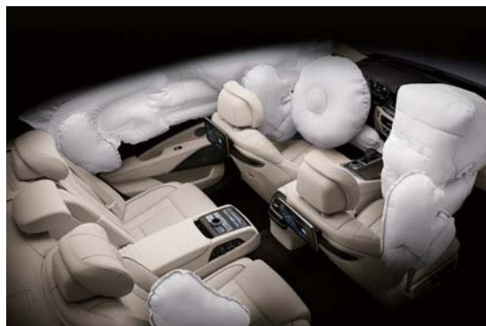
9 에어백 시스템 충격의 정도와 탑승객을 감지해 전개를 제어하는 앞좌석 에어백은 2인용 에어백을 포함해 운전석 무릎, 앞·뒤 전복방지 사이드 에어백, 커튼 에어백 등 총 9개 에어백을 적용했다.
