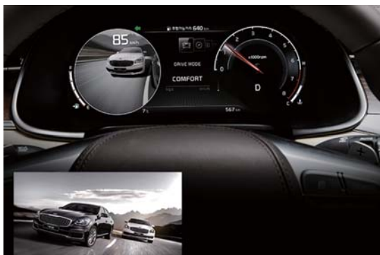
후측방모니터(BVM) 운전자가 방향지시등 조작시, 측방 광각 카메라를 이용해 해당 방향의 후측방 영상을 클러스터 화면에 표시해 편리한 주행을 도와준다.
